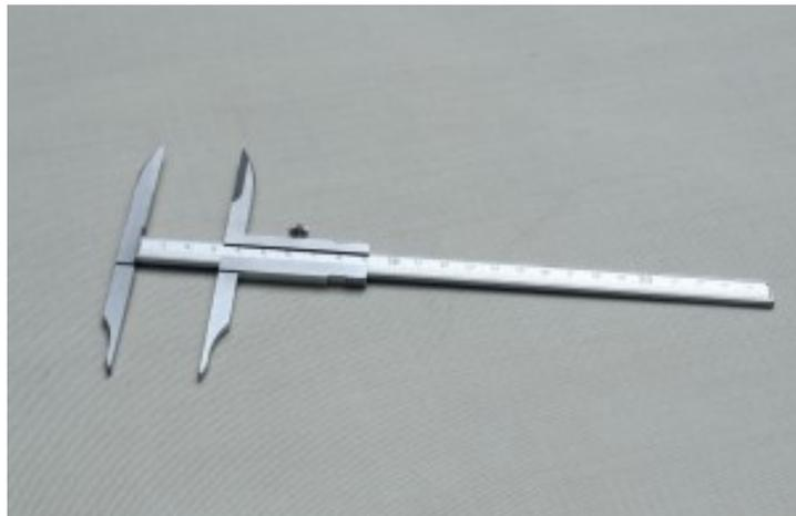
Strumento di precisione per misure antropometriche in acciaio inossidabile, di produzione svizzera.
