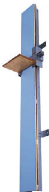
Lo stadiometro di “Harpenden” è un misuratore di altezza di grande precisione con lettura numerica (digitale) su contatore.
